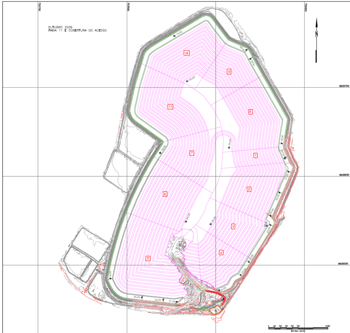
Figura 7.3 – Faixas de reabilitação do DRS1 ao final da etapa de conformação, com resíduo do filtro prensa (Fonte: D1-8400-54-G-114-R03, LPS/2017)
