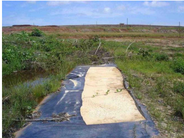
Figura 7.9 – Retirada de Amostra da Geomembrana da célula antiga para Avaliação no Laboratório da ENGEPOL – Jul/2007 – Célula Sul (RECORD, 2008)
