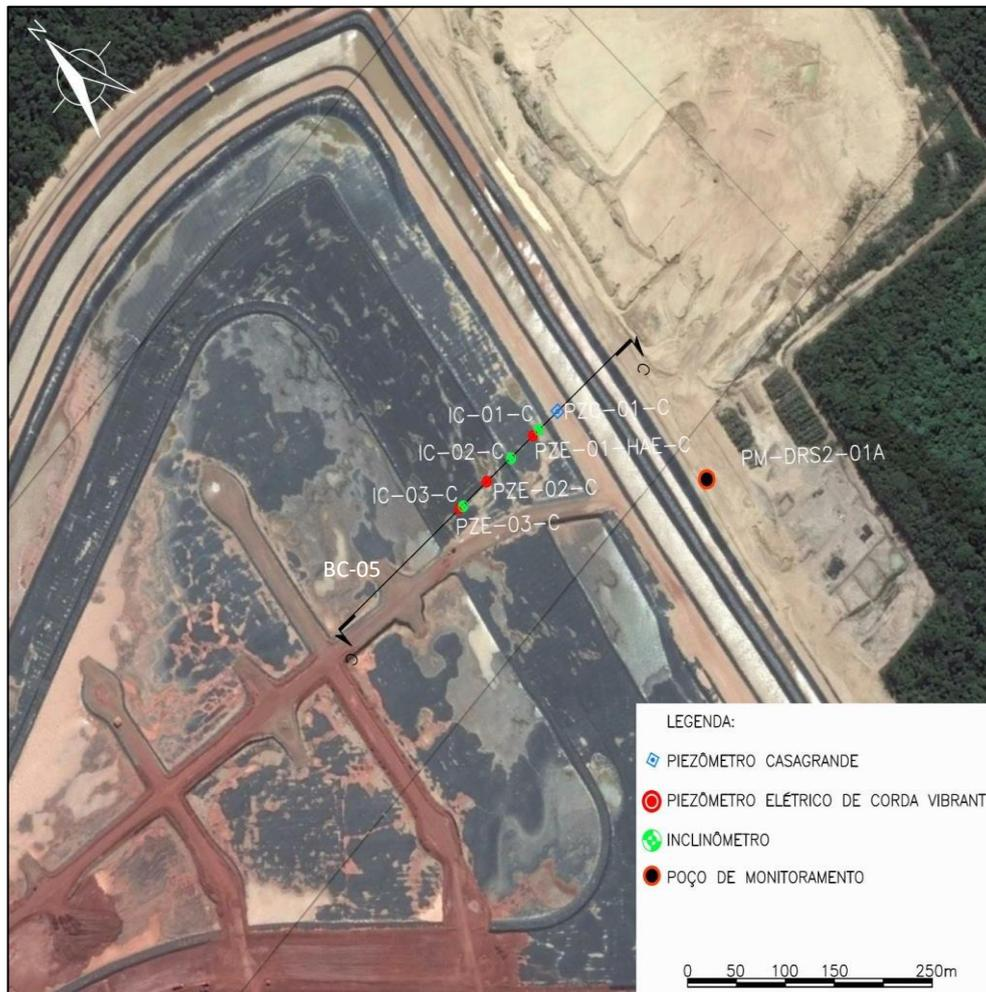
**Figura 7.9 – Localização em planta da instrumentação instalada na Seção C (PIMENTA DE AVILA, 2022)**
