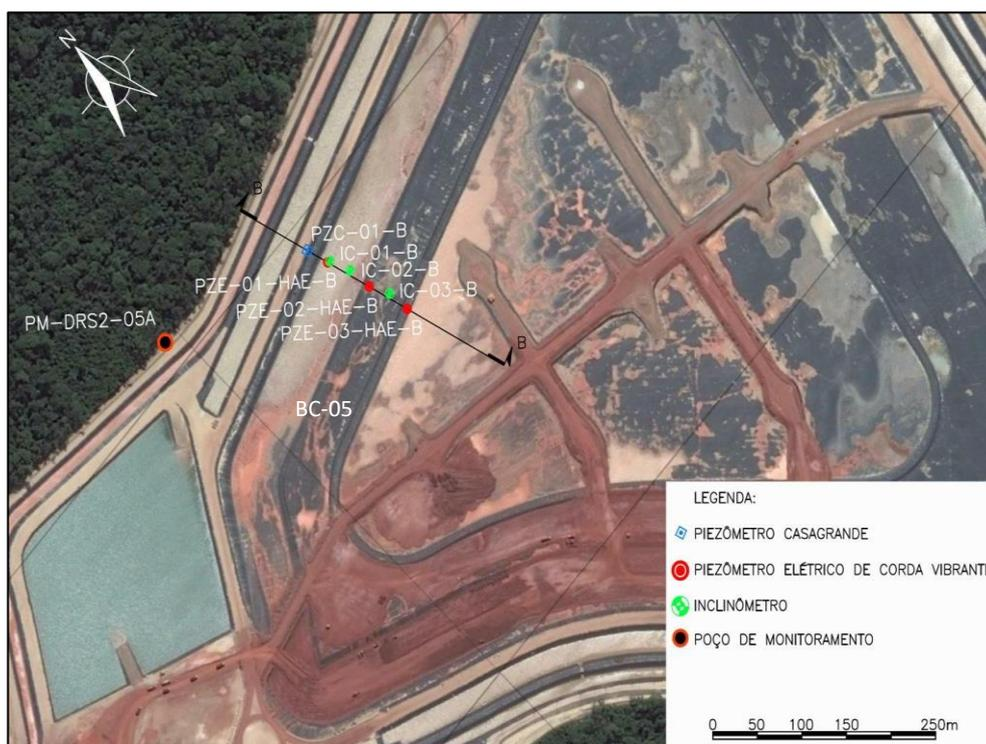
**Figura 7.6 – Locação em planta da instrumentação instalada na Seção B (PIMENTA DE AVILA, 2022)**
