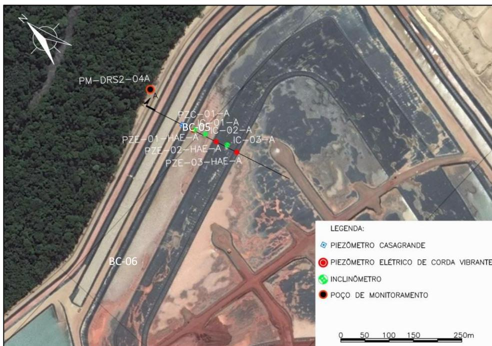
**Figura 7.3 – Locação em planta da instrumentação instalada na Seção A (PIMENTA DE AVILA, 2021)**
